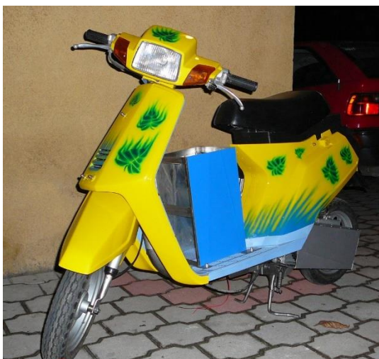
Skuter z napędem elektrycznym, zdjęcie z pracy inż., autor: Krzysztof Mańka, promotor dr inż. Rafał Setlak
